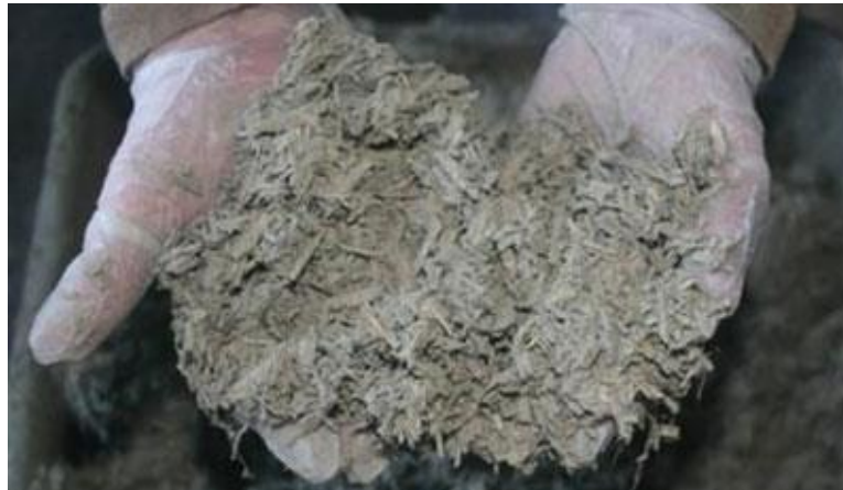
Konopljin beton pred vgradnjo (vir: konopko.si)
